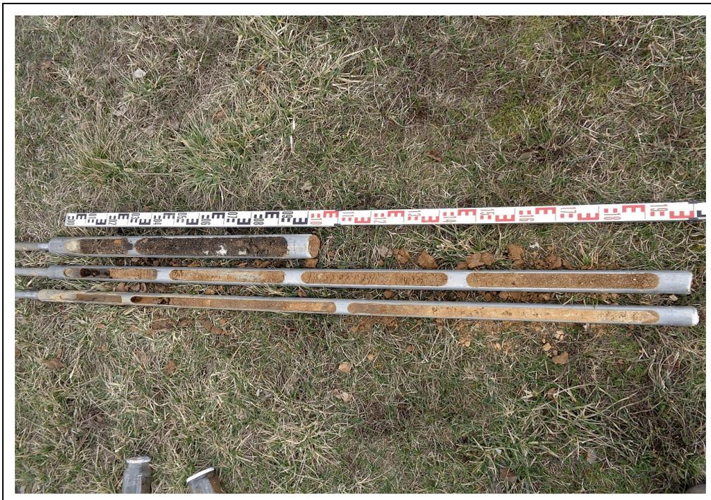
Foto 2: Bohrung BS 2, ausgelegt von links oben (0,0 m) nach rechts unten (- 4,7 m)
