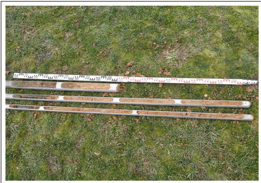
Foto 8: Bohrung BS 8, ausgelegt von links oben (0,0 m) nach rechts unten (- 4,8 m)
