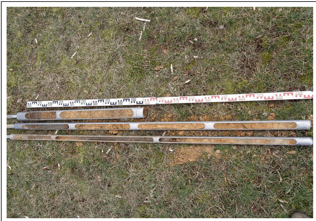
Foto 4: Bohrung BS 4, ausgelegt von links oben (0,0 m) nach rechts unten (- 3,7 m)
