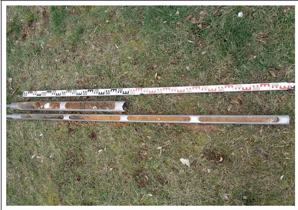
Foto 9: Bohrung BS 9, ausgelegt von links oben (0,0 m) nach rechts unten (- 2,7 m)
