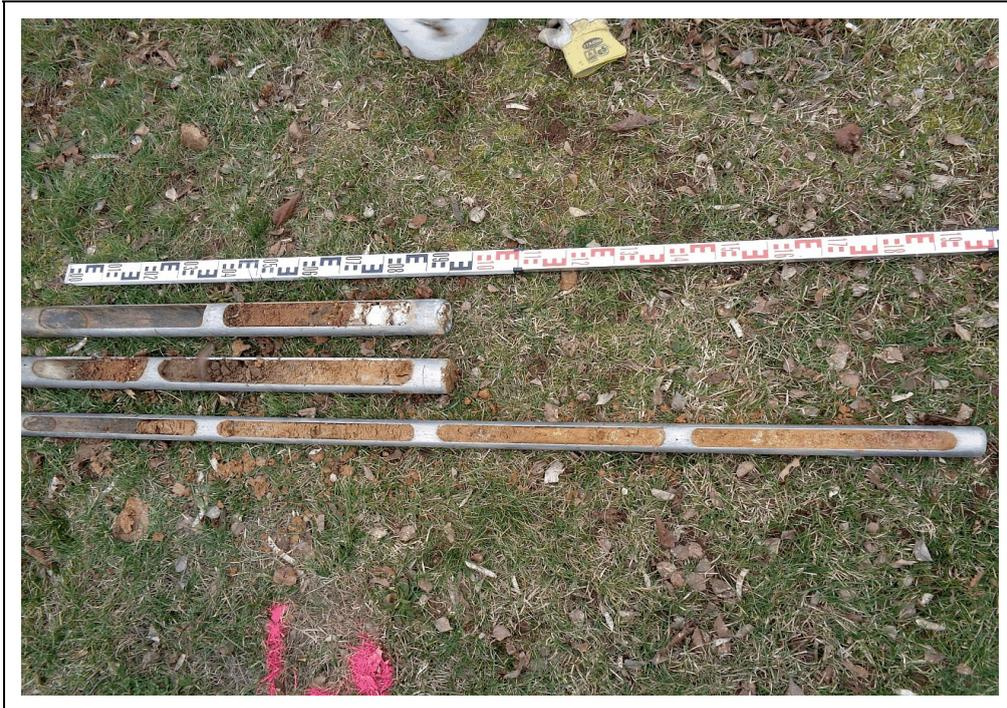
Foto 1: mittlere und untere Sonde: Bohrung BS 1, ausgelegt von links oben (0,0 m) nach rechts unten (- 2,6 m); obere Sonde: Bohrung bei -0,60 m abgebrochen (Beton!)
