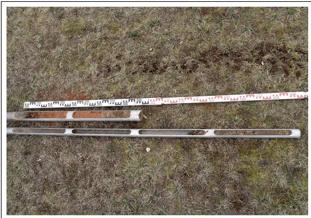
Foto 6: Bohrung BS 6, ausgelegt von links oben (0,0 m) nach rechts unten (- 1,75 m)
