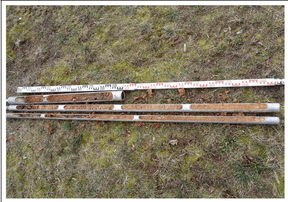
Foto 7: Bohrung BS 7, ausgelegt von links oben (0,0 m) nach rechts unten (- 4,3 m)
